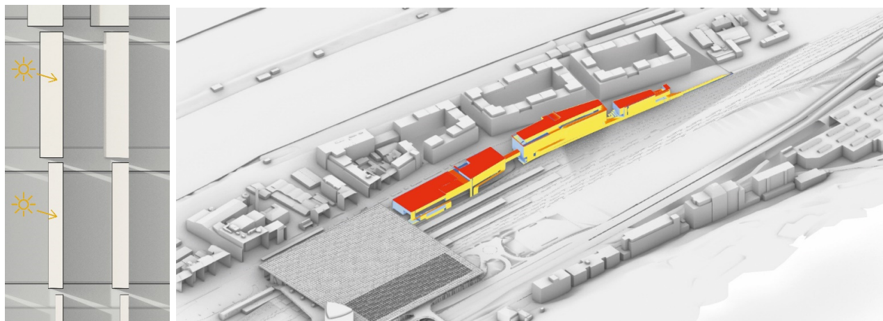
Obr. 02 Diagram solárních zisků a vyplývající koncepce stínění
