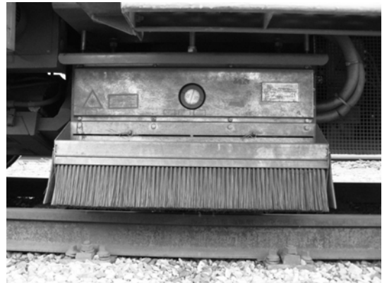
Obrázek 3: Instalované měřicí zařízení na MVŽSv
