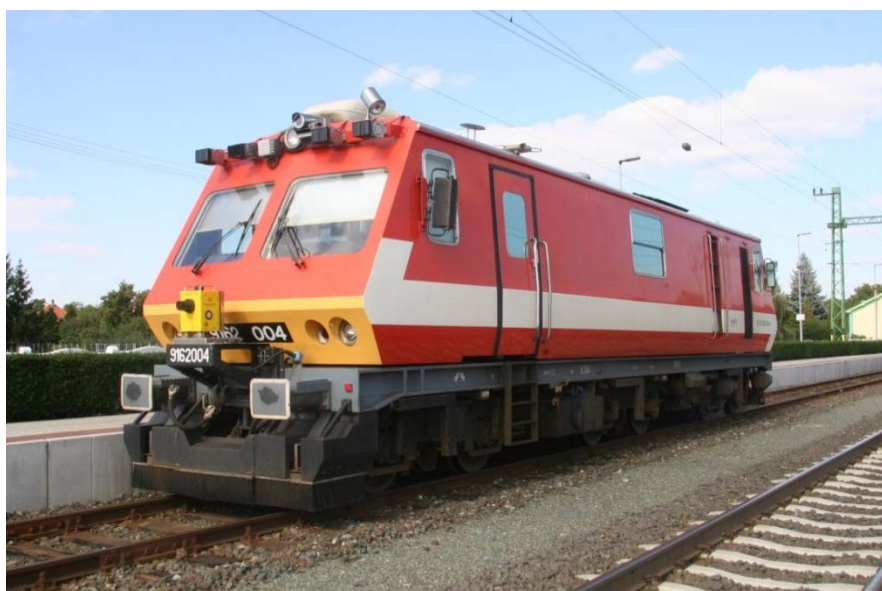
Obr. 2: Měřicí vůz EM-120 pro GPK a prostorovou průchodnost tratí (FMK-004)
