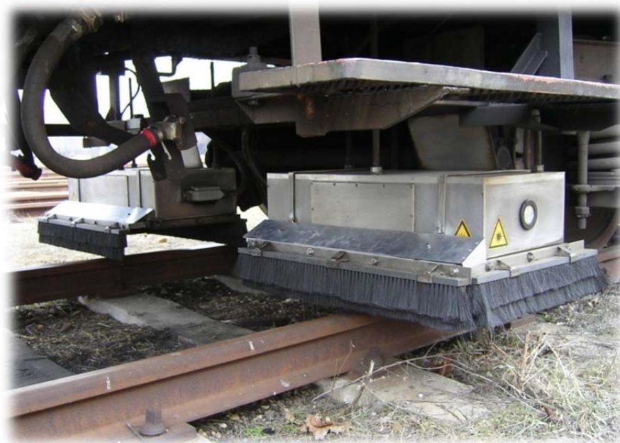
Obr. 8: Zařízení pro zjištění profilů kolejnic na SDS
