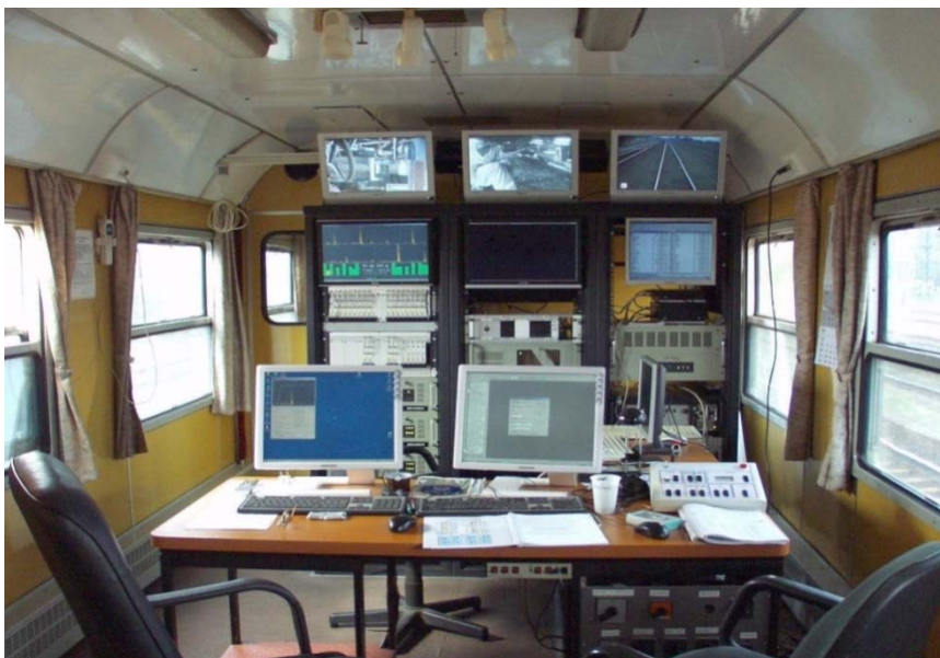
Obr. 7: Ovládací stanoviště měření na palubě SDS
