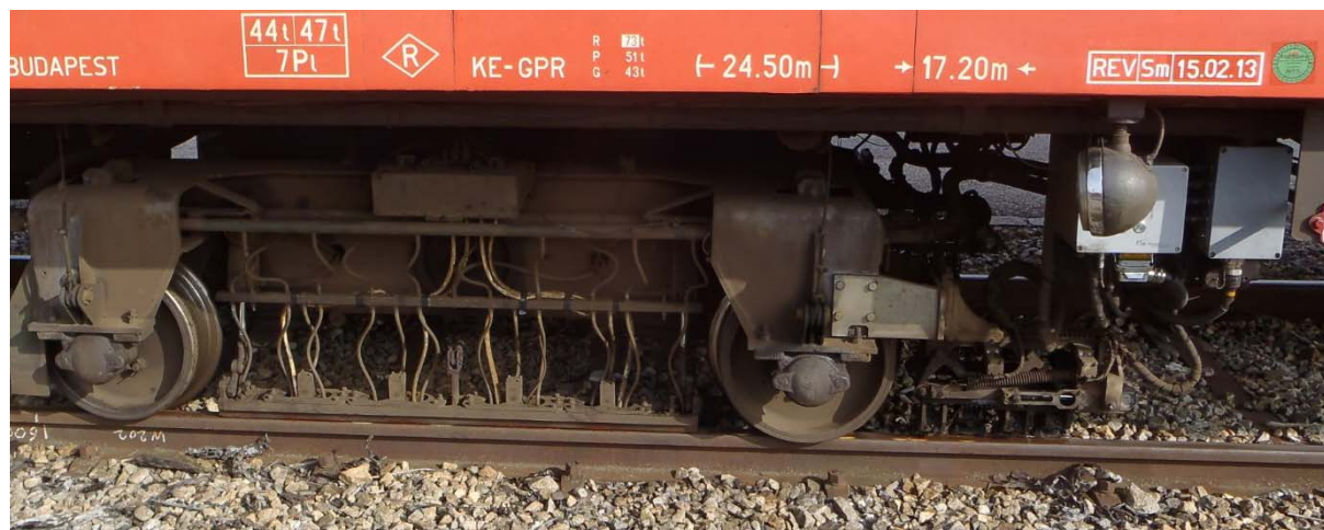
Obr. 6: Měřicí podvozek a ližina obsahující defektoskopické sondy u SDS
