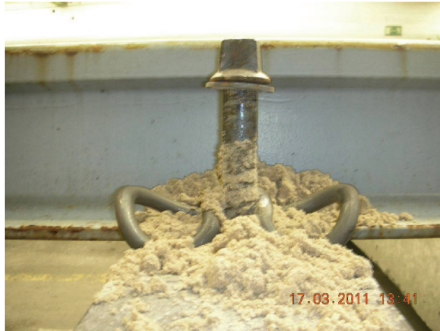
Obr. 6 Zkouška montáže uzlu upevnění znečištěného pískem
