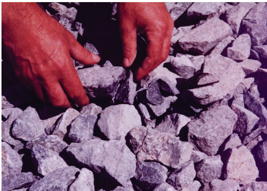
Obr. 1 Zrna kameniva rozlámaná po přejezdu těžkého válce
