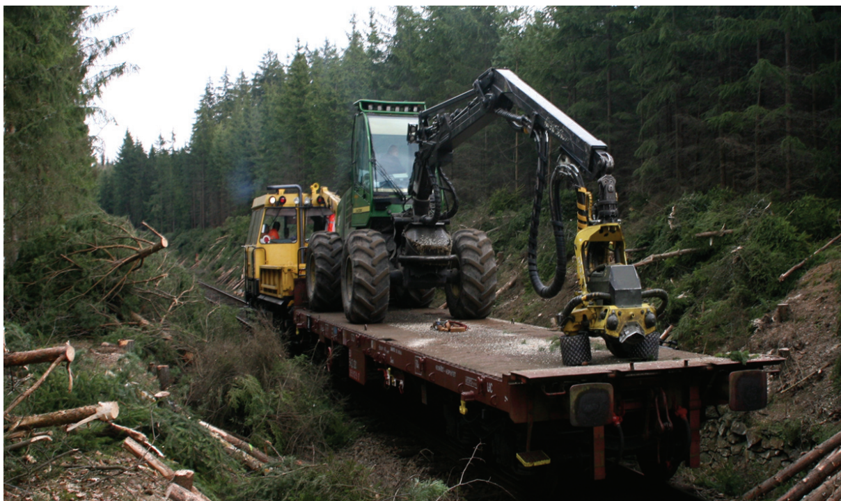
Zkušební využití Harvestoru a plošinového vozu při kácení*
