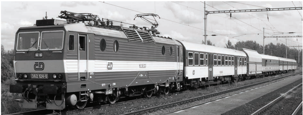
Obr. 5 Souprava zkušebního vlaku s nákladním vozem Talns a měřicím vozem VÚKV doplněná o 3 brzdící vozy
